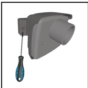
Ruotare completamente da un lato per avere accesso ai fori di fissaggio.
